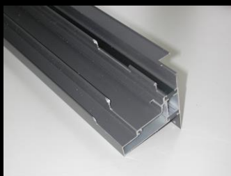
引き違い窓枠端部加工
